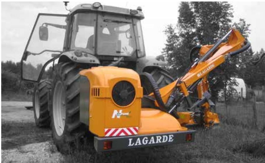
Modèle Neptune II Épareuse à bras déporté (1300 mm), soit un avancement de 2,50 m entre les axes d'attelage et l'avant du groupe de broyage.
